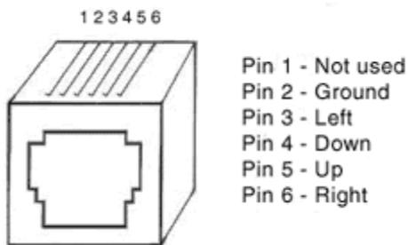
Usted tendrá que soldar un cable en cada pin de 2 a 6.
