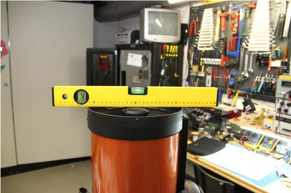
Luego pon el nivel encima del tubo perpendicular al brazo y con el mando mueve el tubo en Rate 6 y 7 hasta que la burbuja se clave en centro.
