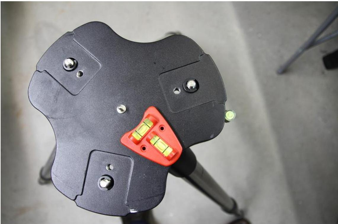
Yo como veris en esta foto, le acopl un nivel fijo de burbuja a la montura, calibrandolo con con otro nivel de cruceta. Esto te facilitar un nivelado rapido en el lugar de observacion.
