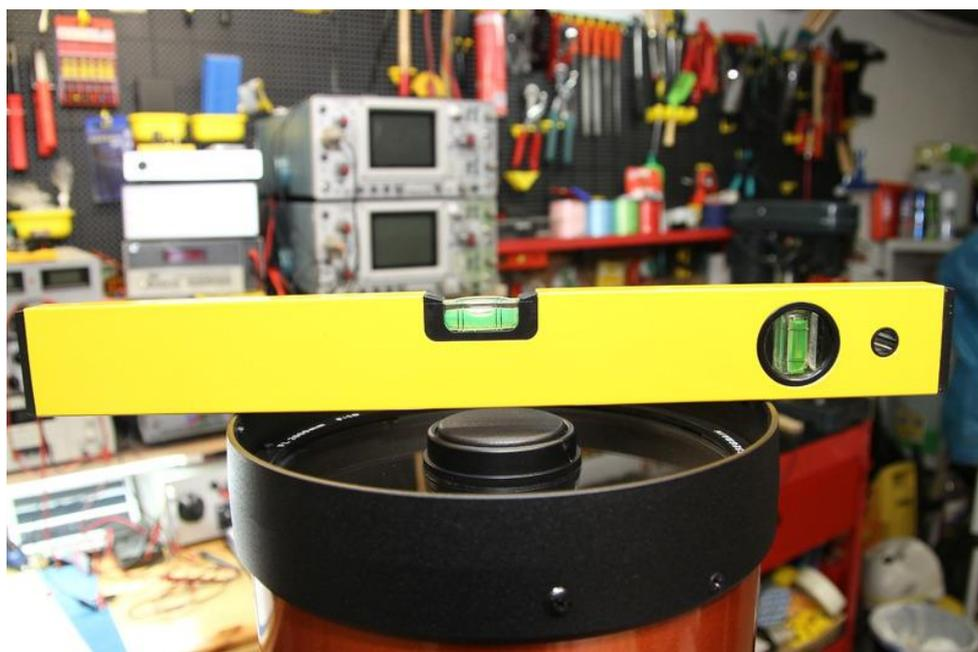
Luego marcas dos rayitas diferentes mediante tip-ex con pincel en el eje ALT de la montura. Con esto tendrás el tubo perfectamente perpendicular a la montura y podrás más adelante hacer el ajuste fino de latitud con la polar.
