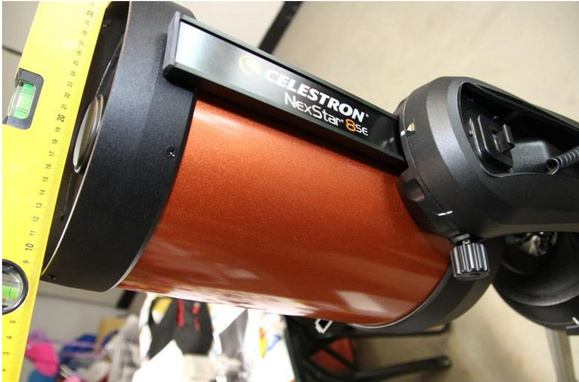
5 ahora monta la cuña con la latitud fijada a ojo sobre la plataforma y sobre esta, la montura del Nexstar.
