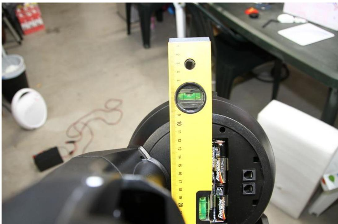
Luego marcas dos rayitas diferentes mediante tip-ex con pincel, en el eje AZIMUT de la montura. Con esto tendras el tubo perfectamente paralelo al meridiano cuando la montura est alineada con la polar.
